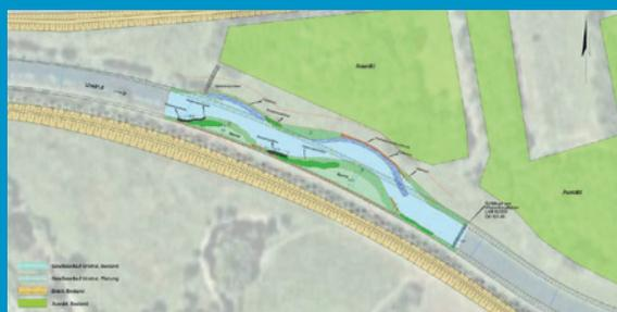
Im zweiten Abschnitt (rechts) wurde durch Aufweitungen der Unstrut und Beseitigung der Uferbefestigungen die Gewässerstruktur erheblich aufgewertet. So wurde eine eigendynamische Entwicklung ermöglicht.
