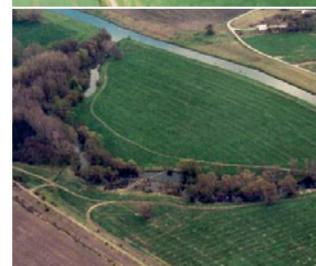
Das Bild links unten zeigt den ehemals abgeschnittenen Altarm der Unstrut. Oben ist die neu angelegte Geländemulde zu erkennen, über die der Altarm bei steigendem Wasserstand gespeist wird.
